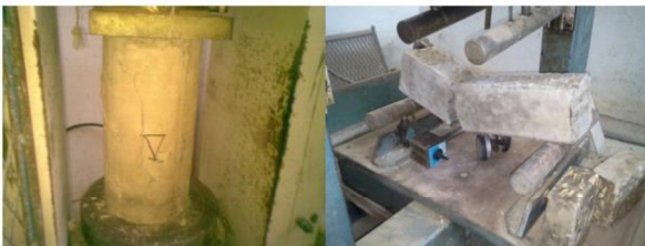
Gambar 8. Pengujian sampel beton
