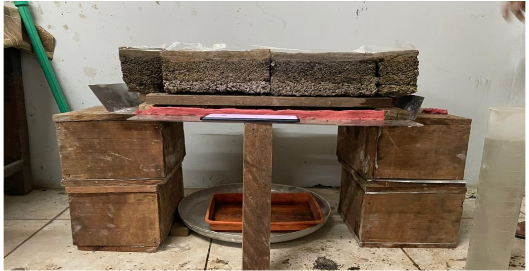
Gambar 3. Briket Perekat Fly Ash (Sumber: Data Primer, 2022)
