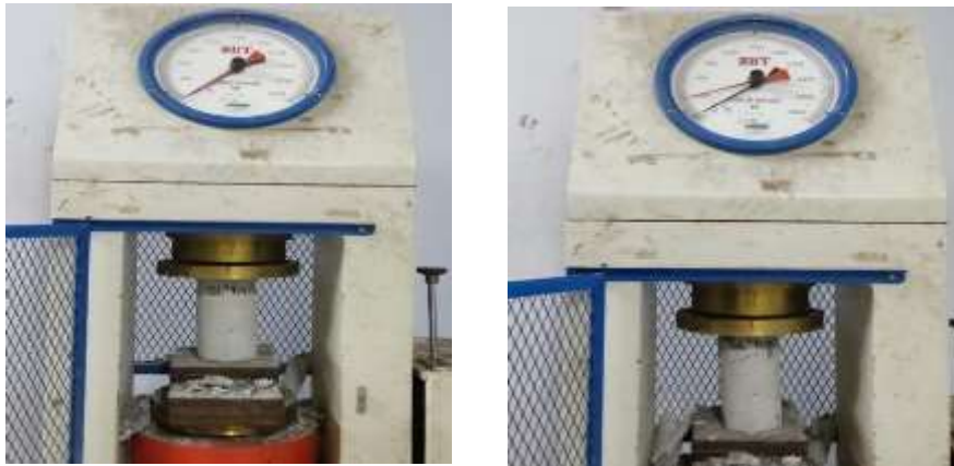
Gambar IV 4 Pengujian Kuat Tekan Beton Silinder Limbah 1000%.
