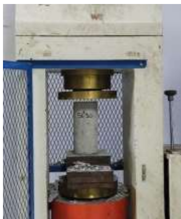
Gambar IV 3 Pengujian Kuat Tekan Beton Silinder Limbah 50%.
