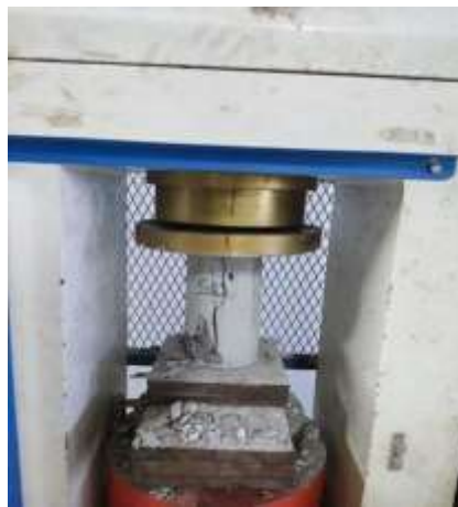
Gambar IV 2 Pengujian Kuat Tekan Beton Silinder Normal (SN)
