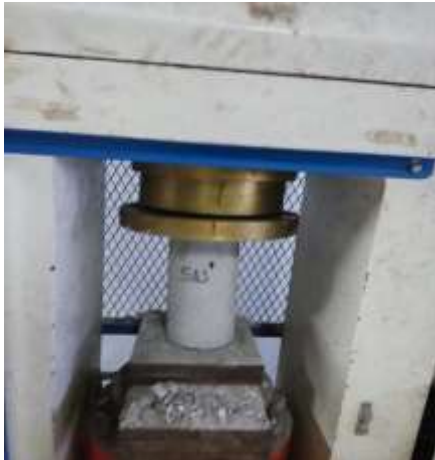
Gambar IV 2 Pengujian Kuat Tekan Beton Silinder Normal (SN)
