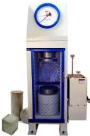
Gambar III. 2 Alat Uji Kuat Tekan
