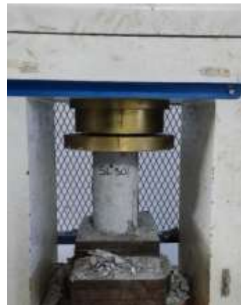
Gambar IV 3 Pengujian Kuat Tekan Beton Silinder Limbah 50%.
