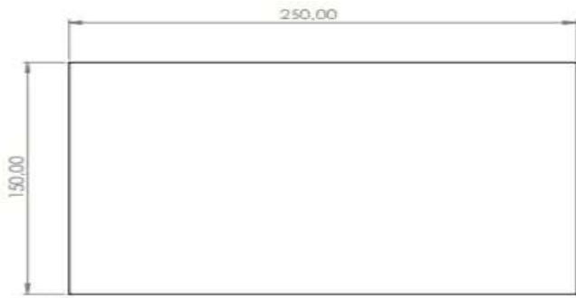
Gambar III.2 Tampak Atas Box Cas Baterai
