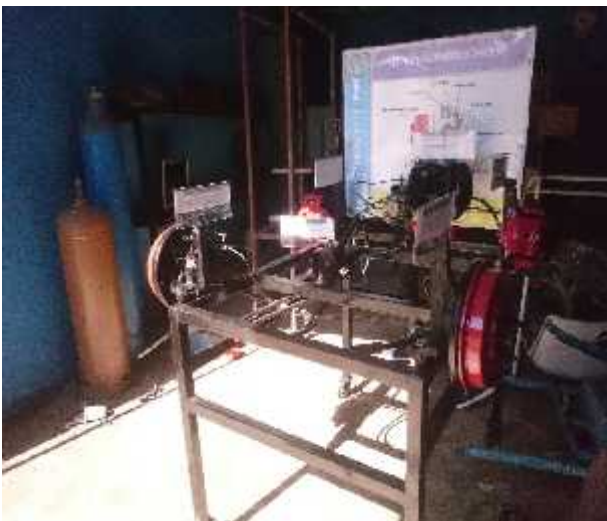
Gambar 1. Trainer Sistem Pengereman ABS Dan Non ABS Mobil Avanza.
