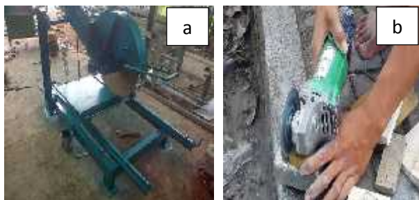
Gambar 1. Mesin pemotong batu alam dengan gurinda; a) gurunda 16 inc; b) salah satu pekerja melakukan pemotongan batu alam untuk model batu nisan
