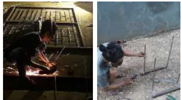
Gambar 8. Praktek pewngelasan pada mitra 2 a) Pengelasan pembuatan pagar b) Pengelasan pembuatan tangga
